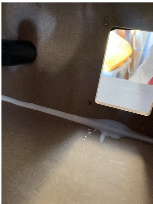
2 – Le giunzioni tra i lati erano un po' debolucce data la fresatura per l'incastro: ho provveduto a rinforzarla con colla vinilica in tutti gli spigoli
