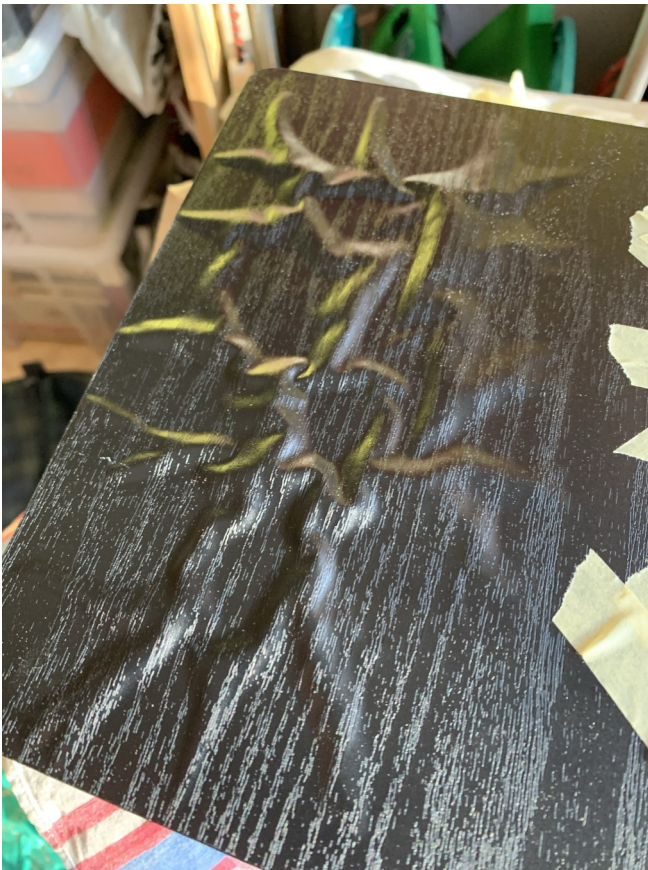
5 – ORRORE !!! I vapori della vernice hanno fatto raggrinzire il rivestimento della cassa ! Per fortuna l'effetto è stato momentaneo, ed il rivestimento è tornato all'aspetto originale.
