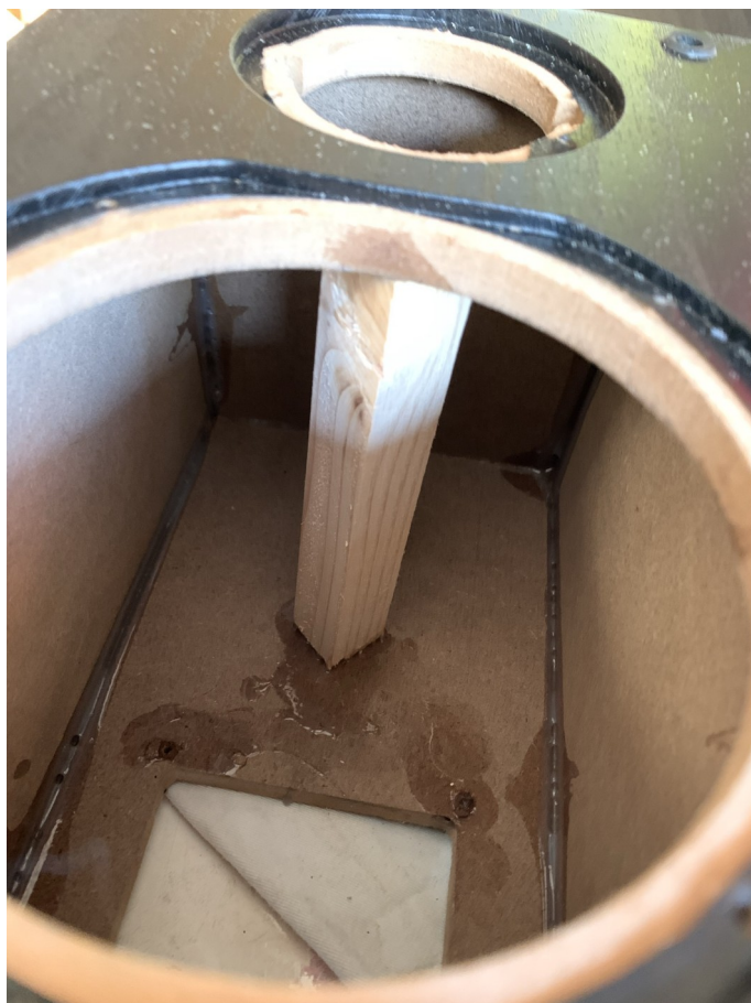
3 – Dato lo spessore non elevato dei pannelli, ho inserito un rinforzo tra i pannelli anteriore e posteriore.
