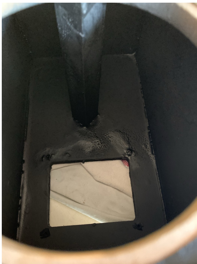
4 – Una bella verniciata a tutto l'interno con vernice antirombo.
