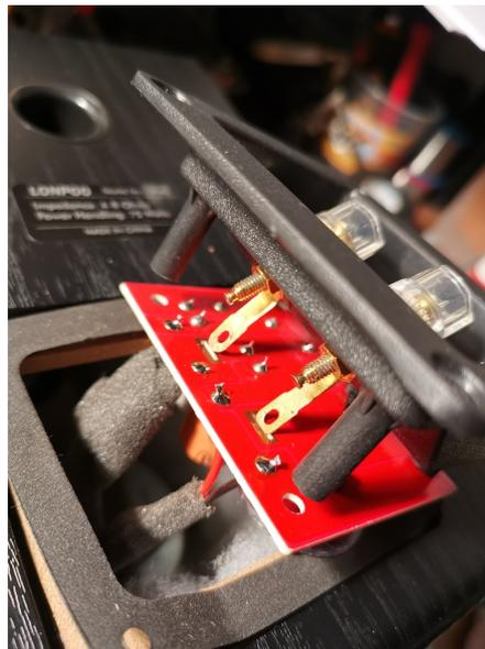
Usate 4 viti autofilettanti lunghe max 12 mm diametro 3mm e avvitate tutto.
