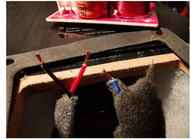
Scartavetrare (per postuma saldatura) e posizionare le lamelle (magari allentando il dado) in modo tale da farle inserire nelle asole predisposte. Appoggiate il filtro sulle colonnine plastiche già presenti sul retro del pannello di plastica.
