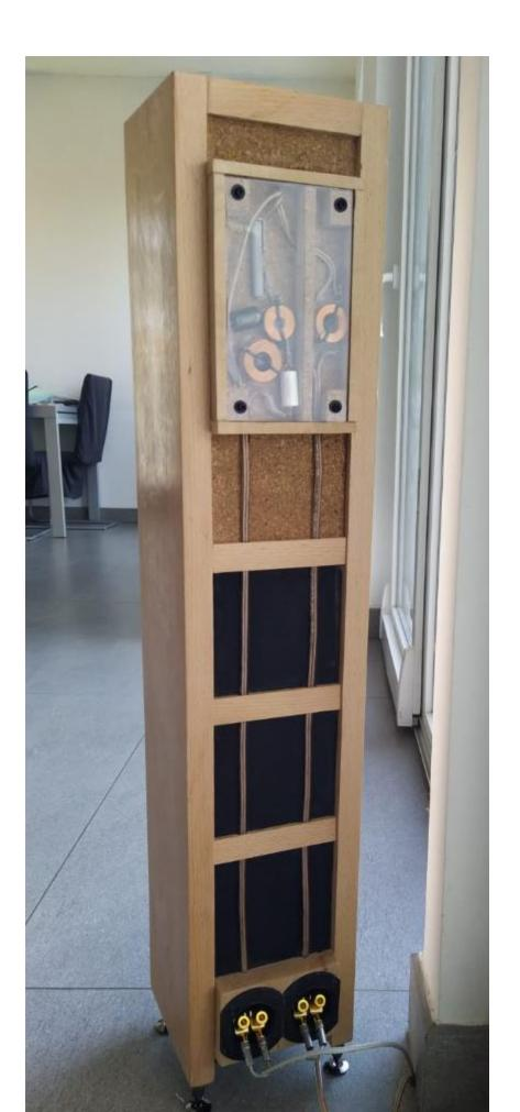
Anche i connettori sono completamente esterni, minimizzando la possibilità di perdite per fessurazione. Dato che per i connettori ho trovato una offerta speciale in busta da 5 su internet, ecco nascere l'idea del bi wiring.
